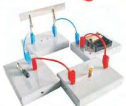
3. İletkenler ve yalıtkanlar: Bakır, alüminyum, demir, plastik, ahşap, kauçuk levha erişim devresi test cihazı ile. Bakır, alüminyum, demir küçük ampul yanar, plastik, ahşap, kauçuk levhalar küçük ampul yanmaz.
