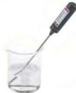
1. Sıcaklık ölçüm deneyi: Dijital termometre
