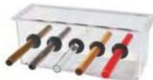
Malzeme termal iletkenlik karşılaştırma deney cihazı
