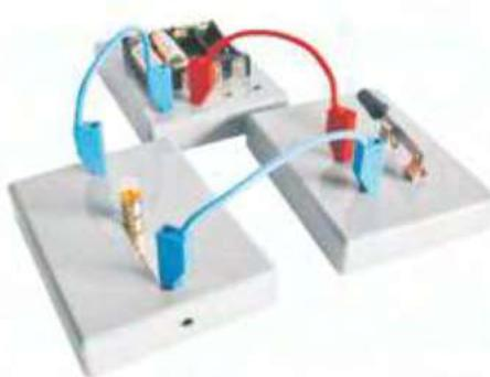
2. Seri devre: Seri devrede, güç kaynağı, küçük ampul 1, anahtar 1, küçük ampul 2 ve anahtar 2 tel ile sırayla bağlanır ve anahtar 1 ve anahtar 2 kapatılır ve 2 küçük ampul yanar.
