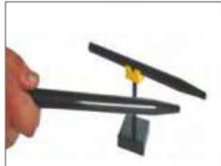
1. Kauçuk çubuklar Kürk e sürtülür. Bu sürtünme elektriklenmeyi sağlar. Bu çubuğu aparatı yaklaştırdığımızda aparatın uzaklaştığını görürüz.
